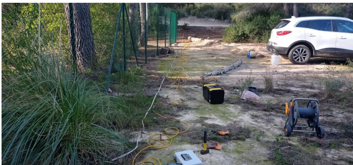
Figura 2.4.- Realització del perfil de tomografia elèctrica a la zona nord de la piscina (Afloraments 59 a 65)
