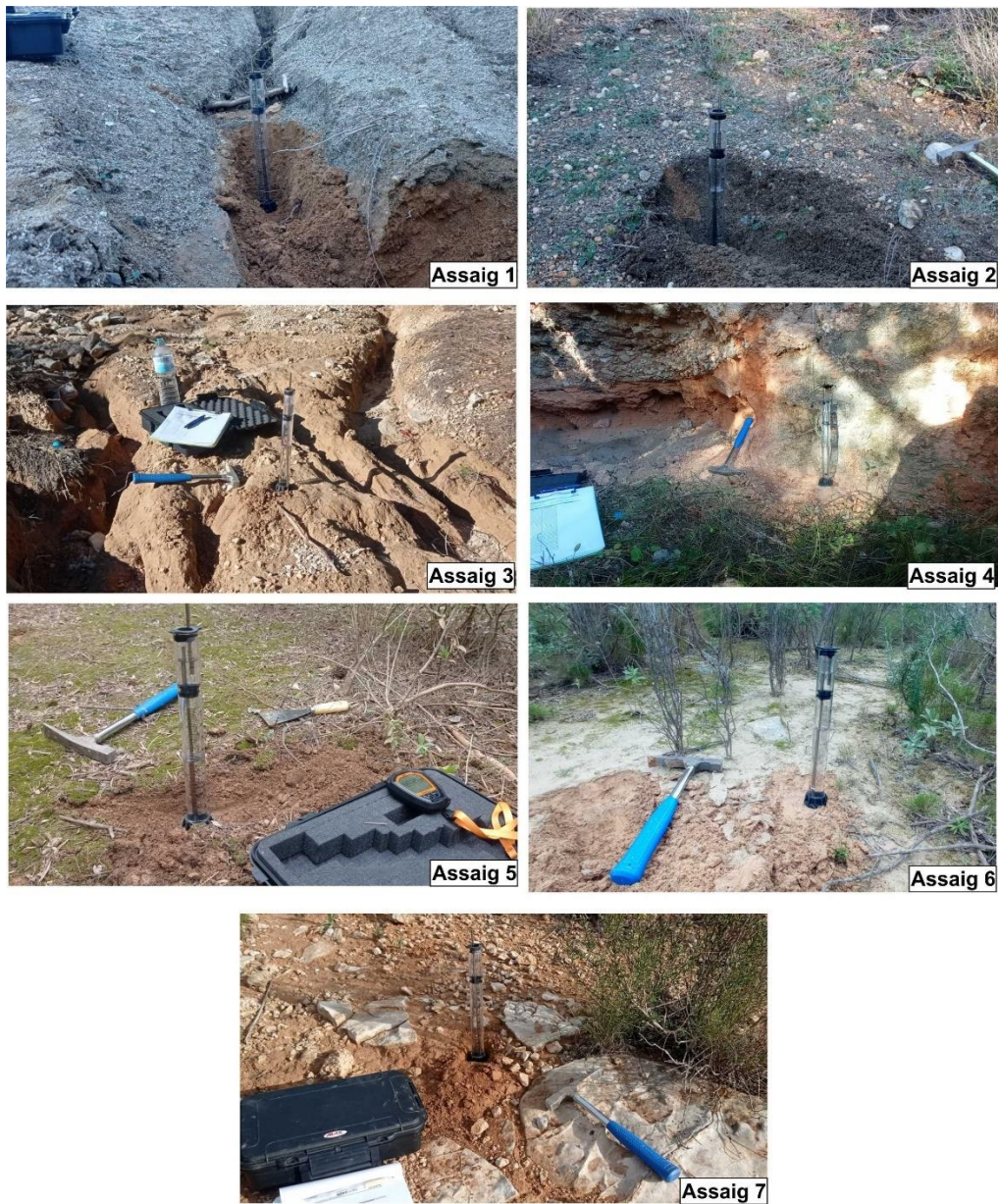
Figura 2.26 .- Imatges dels diferents assajos de permeabilitat realitzats amb infiltròmetre de càrrega variable i en diferents punts del PMU Sant Jordi Bosc (Fotos de l'autor: novembre i desembre de 2021)
